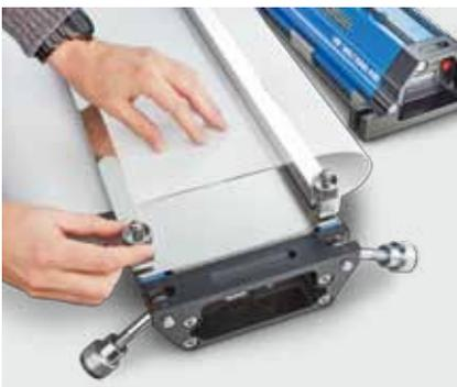
Entsprechend der von Forbo Siegling bereitgestellten materialspezifischen Verbindungsanleitungen können Temperatur, Haltezeit und Druck leicht eingestellt werden. Textanzeigen auf dem Display führen den Benutzer sicher durch das Menü. Der eigentliche Verbindungsvorgang läuft vollautomatisch ab.
